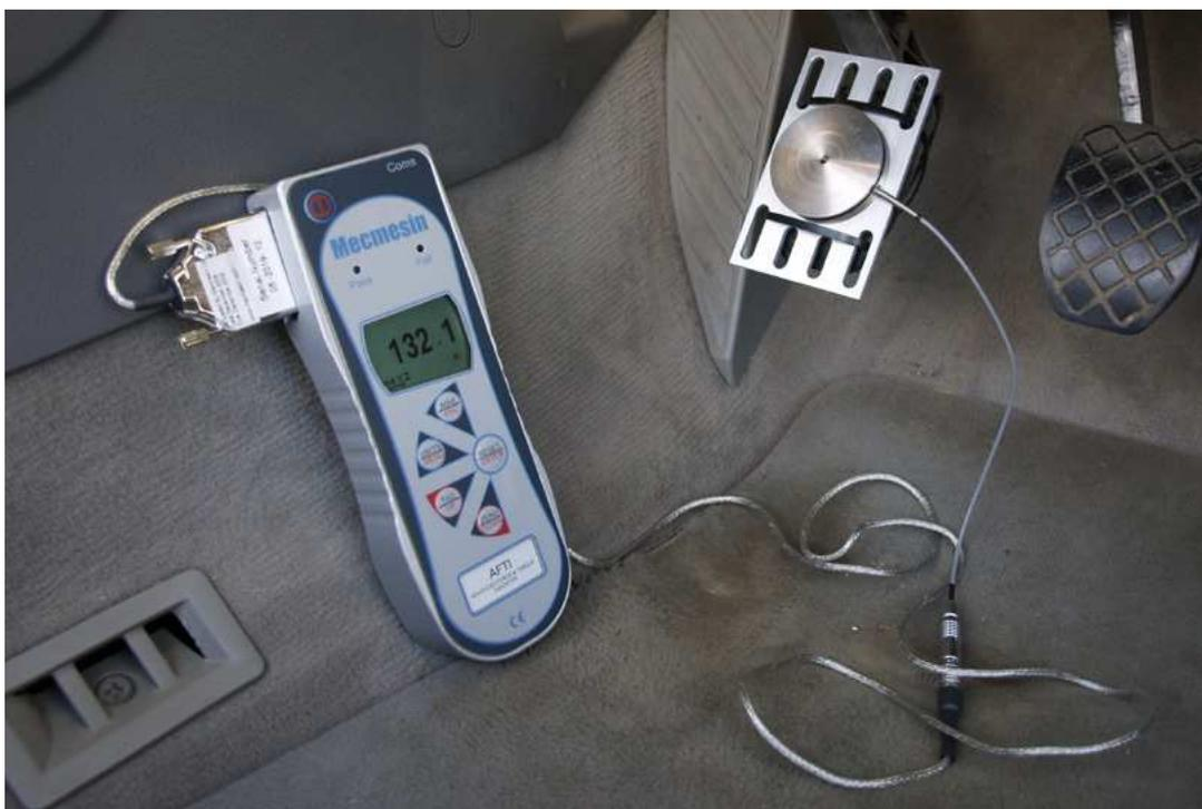
Pedalkraft-Sensor in Betrieb
