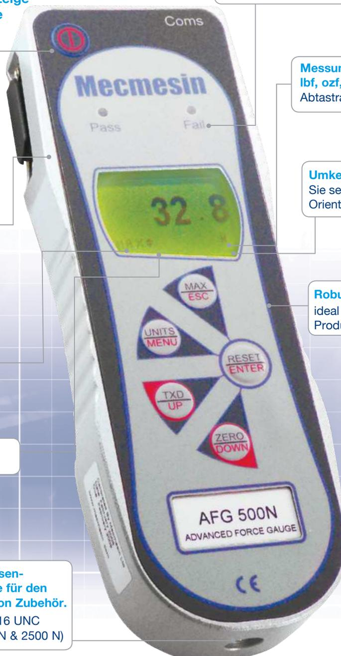
**RS232, Mitutoyo, analoger Datenausgang** für die einfache Datenübertragung. Ein kalibrierter Analogausgang kann wahlweise geliefert werden
