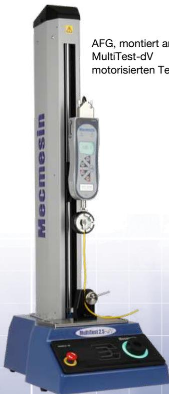
AFG, montiert an einem MultiTest-dV motorisierten Teststand
