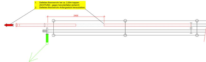
**Schritt 3: Neues Brennerrohr montieren**
