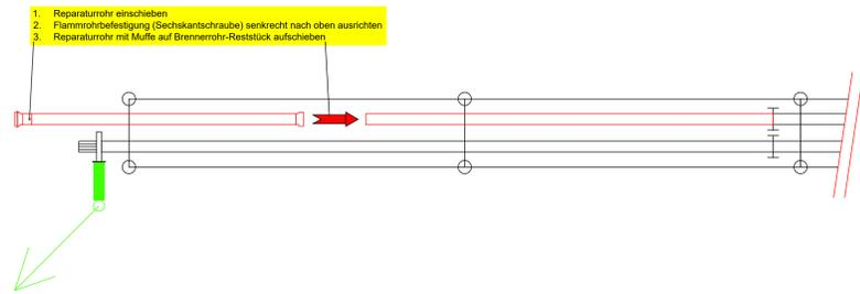
**Schritt 4: Neues Brennerrohr sichern**
