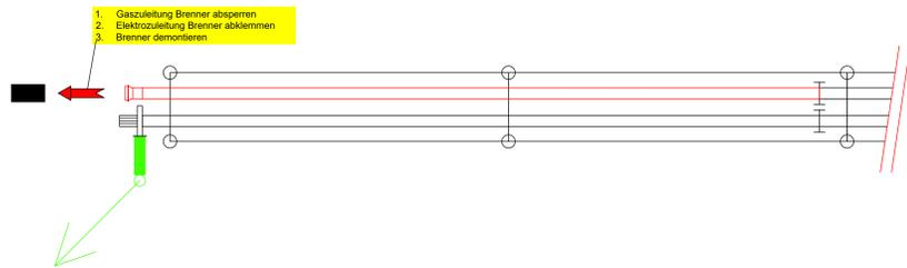
**Schritt 2: Defektes Brennerrohr demonstrieren**
