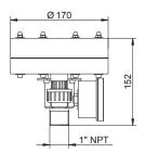
Vakuumregler mit Flanschanschluss (Flansch DN25 / PN40 mit Nut gemäß EN1092 Form D)
