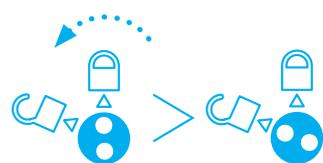
Mithilfe der Sicherungsschraube **lösen** Sie den Klingenwechselknopf („Schloss auf“).
